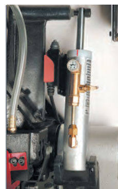
Vérin de descente réglable à double effet
