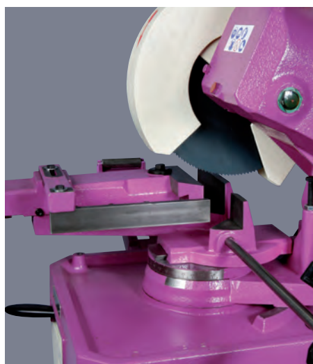
Étai à déplacement avant - arrière pour la finition de gros profilés
