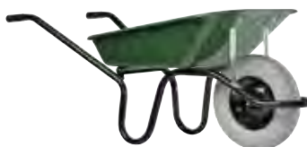
AKTIV PREMIUM Peinte roue gonflée (1049 G) Caisse peinte 90 l, épaisseur 0,9 mm. Châssis CP2i ® avec supports caisse. Roue gonflée Ø 380 mm (PF 150), jante métal flasque. Charge utile 150 kg.
