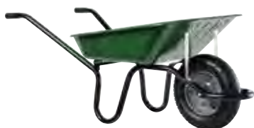
AKTIV PREMIUM Peinte roue gonflée (1049 G) Caisse peinte 90 l, épaisseur 0,9 mm. Châssis CP2i ® avec supports caisse. Roue gonflée Ø 380 mm (PF 150), jante métal flasque. Charge utile 150 kg.
