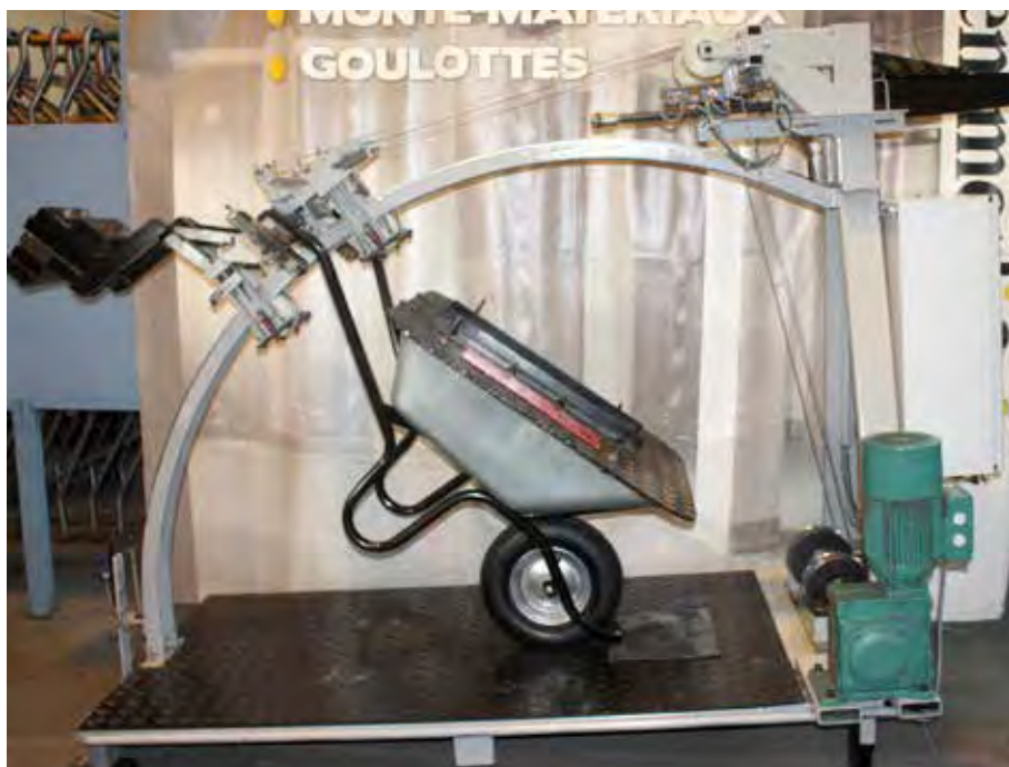
AKTIV EXCELLIUM PLUS 120 testée sur notre banc de déversement.
