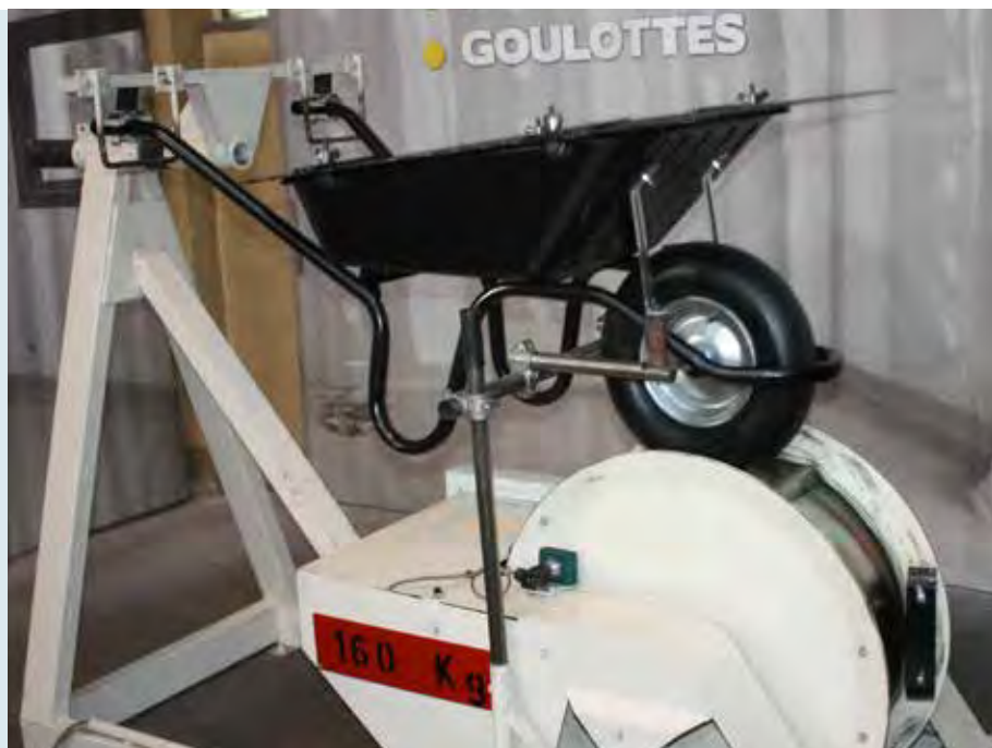
AKTIV EXCELLIUM 100 testée sur notre banc de roulage.
