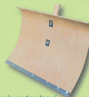
Poussoir contreplaqué 5 plis renfort métal sur taillant
