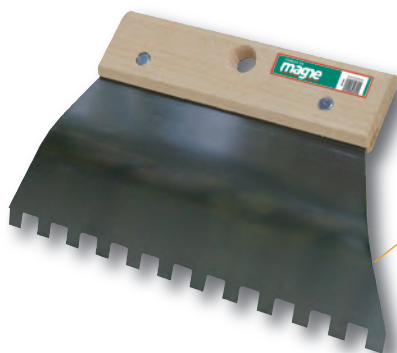
1 Couteau à colle lame courbe dents carrées 6x6 3kgs de colle au m2
