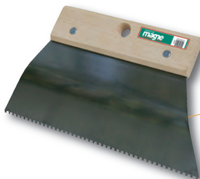
1 Couteau à colle lame courbe dents pointues 2,5x3,5mm 350 à 450g de colle au m2
